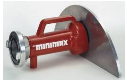
HSC, HSB Ridårör, för 800-1400 l/min vid 5 bar, höjd upp till 10 m, bredd upp till 31 m (8 bar).
