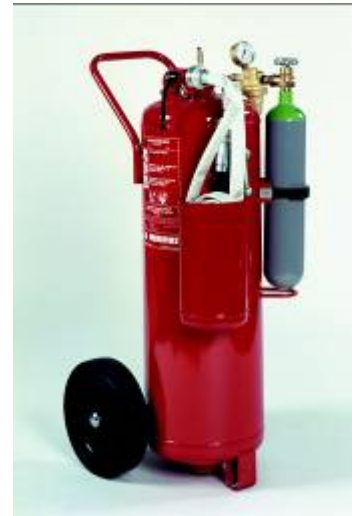
WL 50, WS 50 (50 l) Mobilsaumsläckare med Minimaxol för klass A- och klass B-bränder med spärr- och filmfunktion, frostsäker till -30°C.
