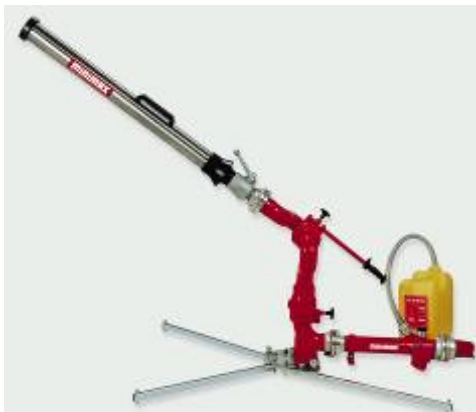
SW 8/10 Skum- och vattenkanon för växling mellan vatten och skum, 800-1000 l/min vid 5-8 bar.
