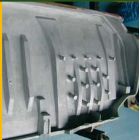
Mitte: Ohne Lärm und CO 2 -Pellets: Formenreinigen mit Laserlicht
