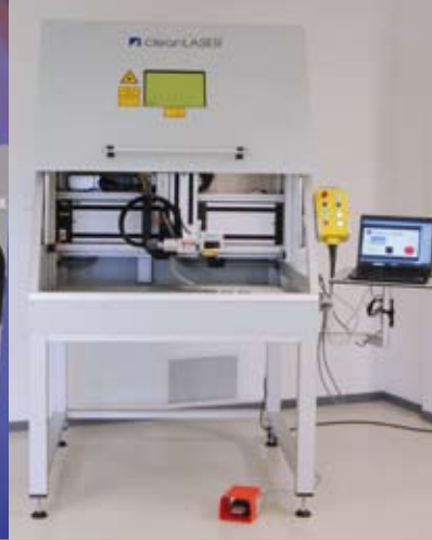
cleanCELL als günstige Workstation mit integriertem 3-Achs-Portalsystem
