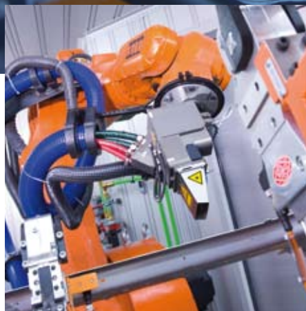
Automatisierte Laservorbehandlung führt zu homogenen und reproduzierbaren Ergebnissen mit Qualitätssteigerungen beim anschließenden Schweißen und Löten (Foto: Audi AG)
