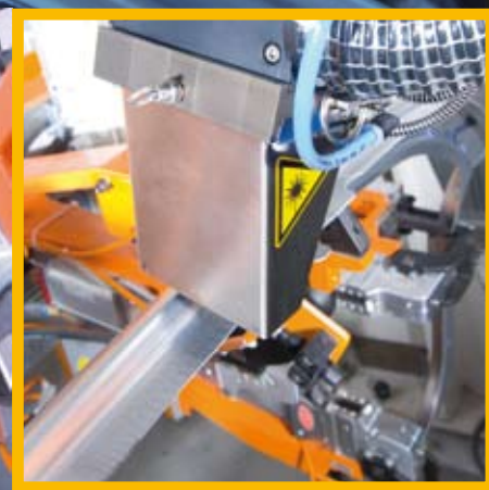
Automatisierte Laservorbehandlung führt zu homogenen und reproduzierbaren Ergebnissen mit Qualitätssteigerungen beim anschließenden Schweißen und Löten (Foto: Audi AG)
