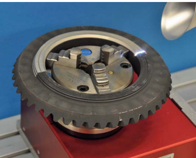
Avlägsnande av fosfatskikt före svetsförbehandling
